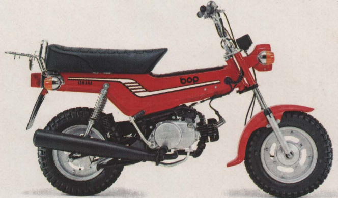
LB3 M Bop. 1-Zyl.-2-Takt-Motor, 49 ccm, 2,96 PS (2,2 kW) bei 4.800 U/min, 40 km/h, 3-Gang-Halbautomatik. Führerscheinklasse 5. Rot, Blau, Schwarz. DM 1.500,-*
