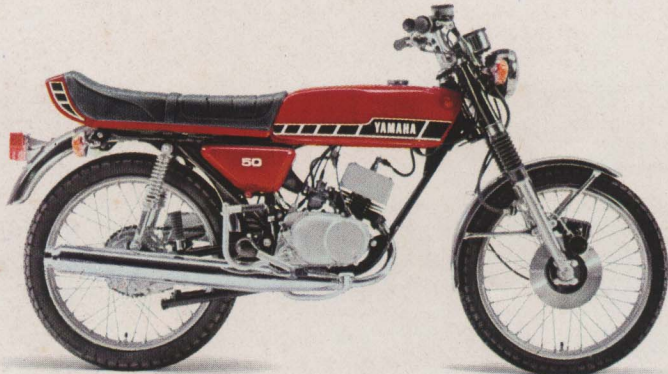
RD50 M. 1-Zyl.-2-Takt-Motor, 49 ccm, 3,0 PS (2,2 kW) bei 5.000 U/min, 40 km/h, 5 Gänge, Scheibenbremse vorn. Führerscheinklasse 5. Rot, Blau, Schwarz. DM 2.050,-*
