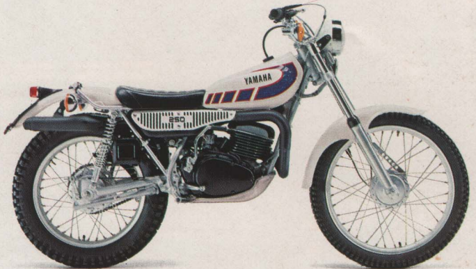
TY250. 1-Zyl.-2-Takt-Motor, 246 ccm, 12 PS (8,8 kW) bei 5.950 U/min, 100 km/h, 5 Gänge. Weiß-Blau. DM 3.700,-*
