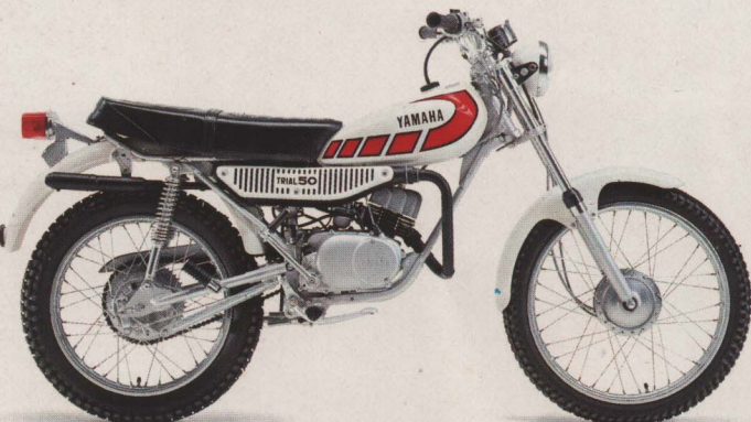
TY50 M. 1-Zyl.-2-Takt-Motor, 49 ccm, 2,75 PS (2,0 kW) bei 5.300 U/min, 40 km/h, 4 Gänge. Führerscheinklasse 5. Weiß-Rot, Weiß-Blau. DM 1.752,-*
