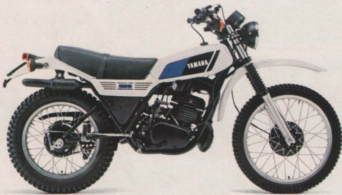
DT250 MX. 1-Zyl.-2-Takt-Motor, 244 ccm, 16 PS (11,7 kW) bei 5.400 U/min, Cantilever-Federung, 109 km/h, 5 Gänge. Weiß. DM 3.800,-*
