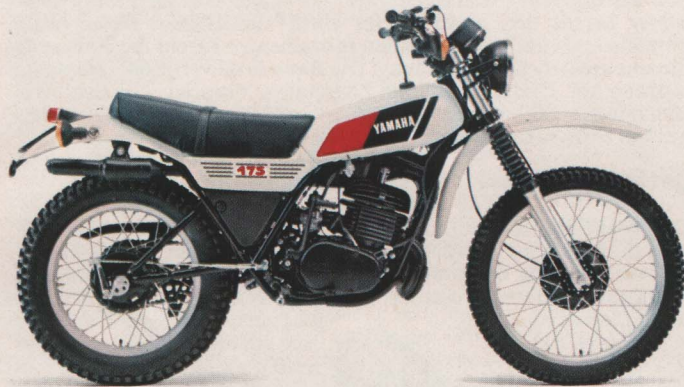
NEU DT175 MX. 1-Zyl.-2-Takt-Motor, 171 ccm, 15 PS (11 kW) bei 7.500 U/min, Cantilever-Federung, 107 km/h, 5 Gänge. Weiß. DM 3.100,-*
