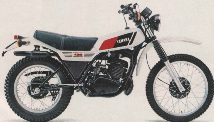
DT400 MX. 1-Zyl.-2-Takt-Motor, 394 ccm, 21 PS (15,4 kW) bei 6.000 U/min, Cantilever-Federung, 120 km/h, 5 Gänge. Weiß. DM 4.100,-*
