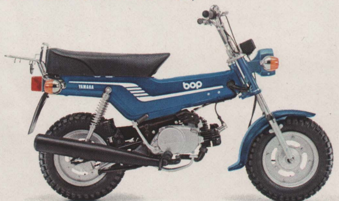
NEU LB3-80 Bop. 1-Zyl.-2-Takt-Motor, 73 ccm, 5 PS (3,7 kW) bei 6.700 U/min, 65 km/h, 3-Gang-Halbautomatik. Führerscheinklasse 1. Blau. DM 1.550,-*
