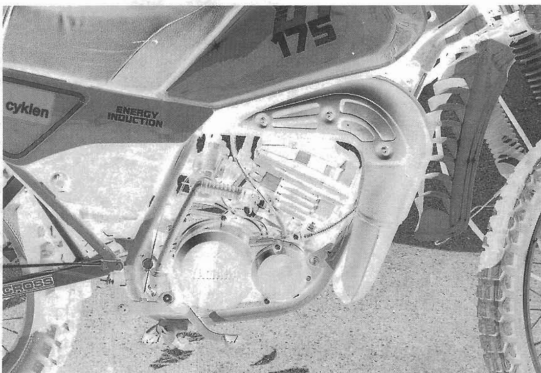
DT 175-motoren yder iflg. Yamaha's oplysninger 17,5 hk ved 7.000 rpm. Men oprindeligt er den konstrueret til en ydelse på 24,5 hk.
