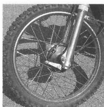
Forhjulet har 130 mm tromlebremse.
